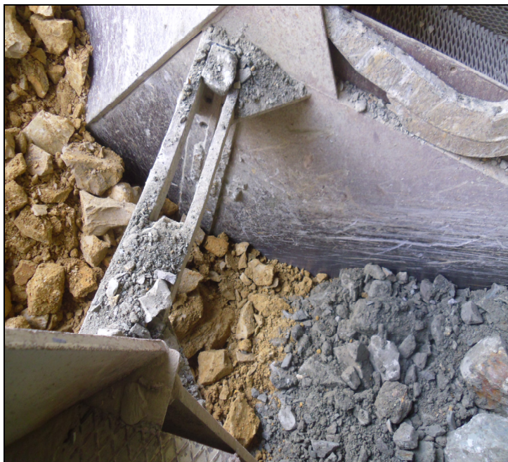
Foto 2.3: Il conferimento in tramoggia da Albarola e Canova avviene di norma simultaneamente, si noti la differenza di colore. Le percentuali giornaliere di provenienza da ciascun sito vengono ottimizzate per avere un mix di tout venant granulometricamente eterogeneo e con titolo carbonatico ottimale. Ciò evita che la marna si impacchi (soprattutto quella più disgregata di Canova) o che i blocchi più grossi (che più facilmente provengono da Albarola) facciano da “tappo”.
