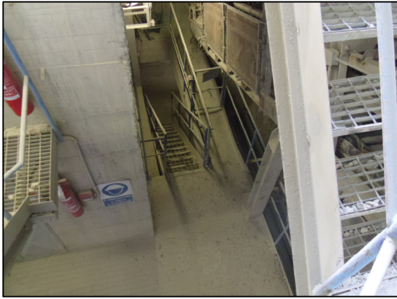
Foto 2.7 e 2.8: La marna ora frantumata prosegue il suo percorso sui nastri trasportatori di cui le foto sopra.
