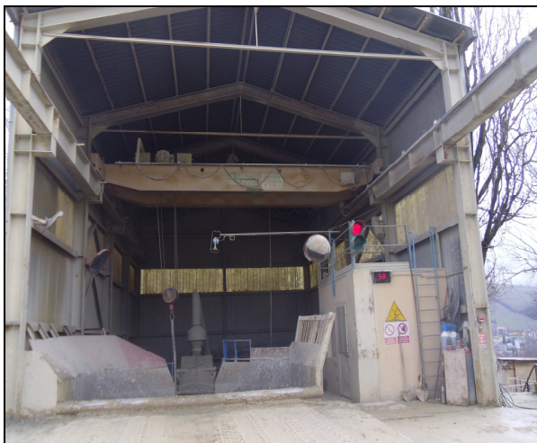
Foto 2.5: In presenza di blocchi di dimensioni tali da non poter essere frantumati ( \text{diam} > 70 \text{ cm} ), si ricorre al carroponte per prelevarli ed estrarli fisicamente dalla tramoggia.
