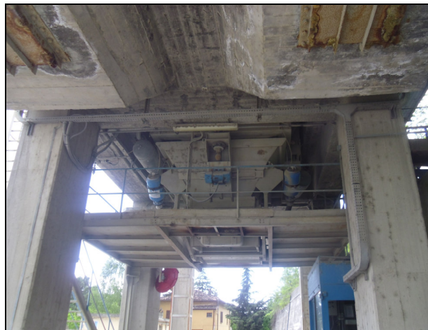
Foto 2.9: La tramoggia di scarico è il punto di arrivo della marna frantumata; da essa confluisce per gravità sul cassone dei mezzi adibiti al trasporto verso la cementeria di Vernasca.
