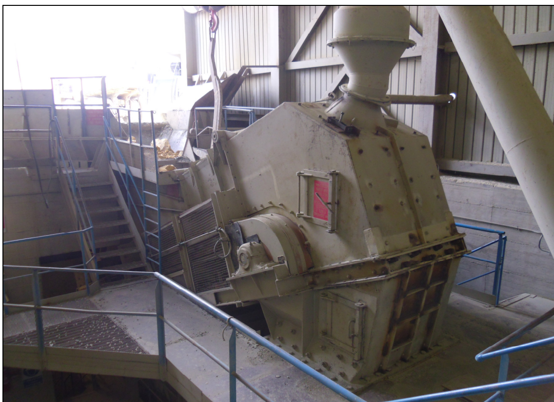
Foto 2.6: La frantumazione avviene nel frantoio a martelli posto a valle della tramoggia, esso è il punto nevralgico meccanico dell'intero impianto.
