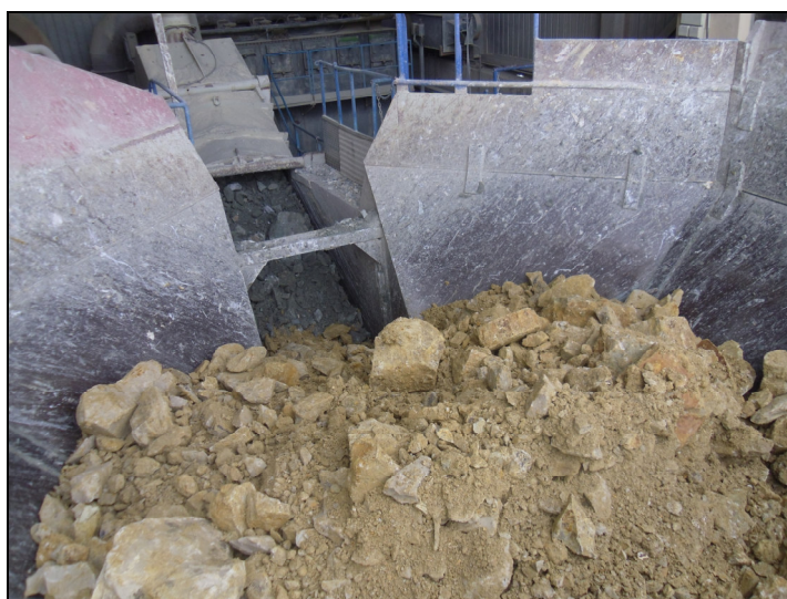
Foto 2.4: Il disintasamento della tramoggia di alimentazione è una delle problematiche ordinarie più ricorrenti, ciò in quanto non è sufficiente il solo controllo visivo di ciò che giunge in entrata. Infatti, soprattutto in inverno col materiale umido, la produzione oraria rallenta considerevolmente per dare il tempo alla marna “impaccata” di scendere lungo il cono.
